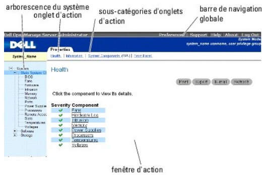
Figure 4-2 illustre un exemple de page d'accueil de Server Administrator pour un utilisateur ayant ouvert une session avec des privilèges d'administrateur sur un système modulaire.
